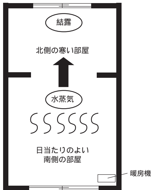
北側の部屋に結露が発生する
