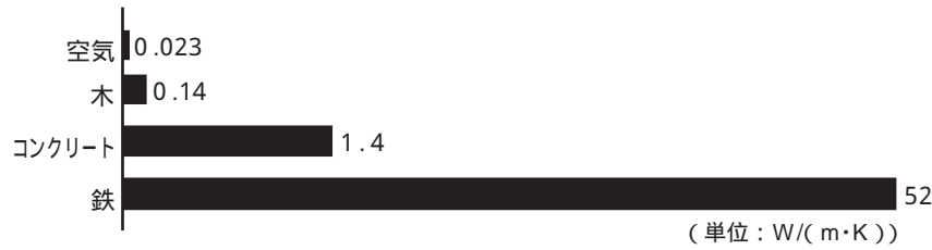
物質(材料)による熱伝導率の比較
